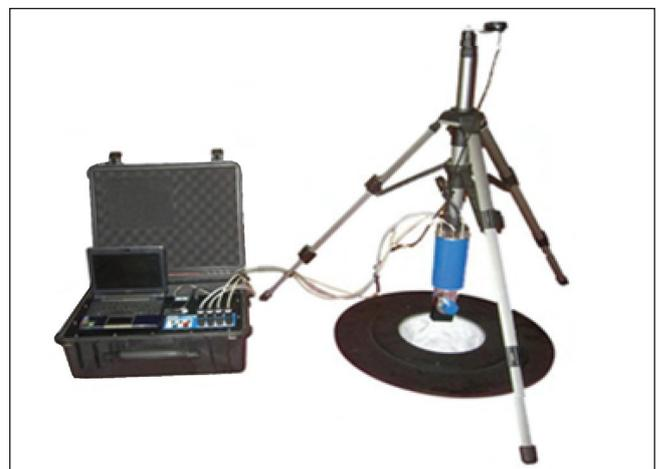
Bild 1: Grubenvolumenscanner GVS, Prototyp II
