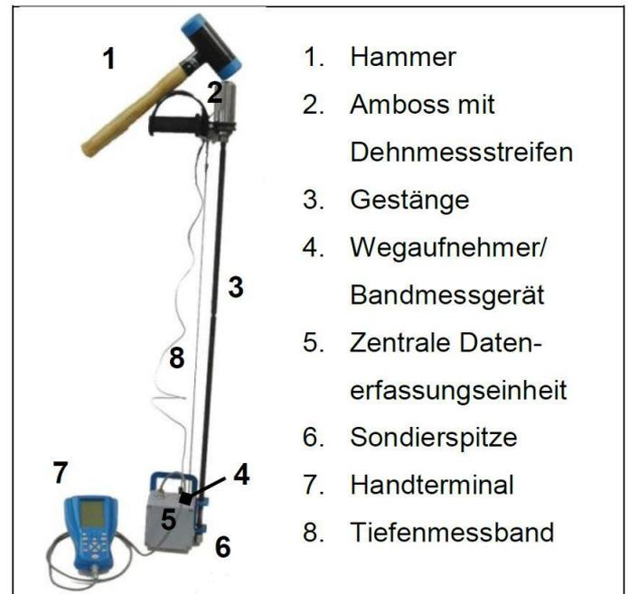
**Bild 1: Schematischer Aufbau der Panda-Sonde (Benz Navarrete 2009), (R 2), (Reichenbach, Schmidt 2008)**
