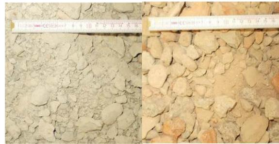
**Bild 3: RC-Beton und RC-Mix; jeweils 0/32 mm**
