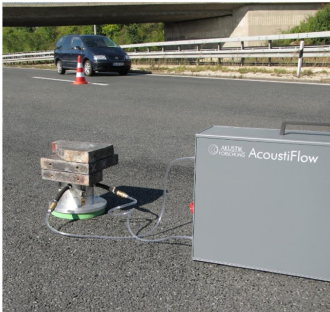
Bild 2: messtechnische Bestimmung des effektiven spezifischen Strömungswiderstands der Fahrbahnoberfläche mit Messsystem AFD – 300 AcoustiFlow®
