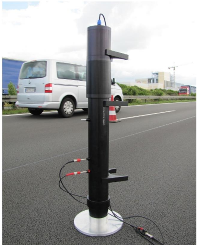
Bild 3: messtechnische Bestimmung des Schallabsorptionsgrads auf Basis des Impedanzrohr-Verfahrens mit dem Messsystem AFD 1000 – AcoustiTube®
