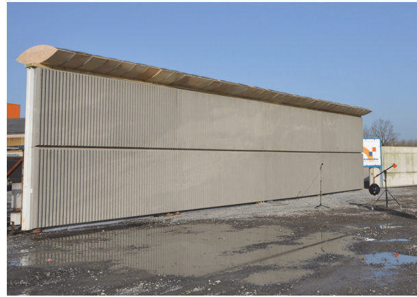
Bild 12: Messaufbau: untersuchte Wand mit Beugungskante (oben), Dodekaeder-Lautsprecher und Referenzmikrofon (mitte)
