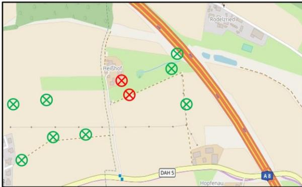
**Bild 2: Schematische Darstellung des Messgebietes mit Dauer- und Intensivmessstationen (rot) und Intensivmessstationen (grün)**
