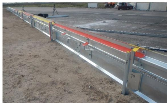
Bild 2: ESP 4.0 mit angebrachtem Unterfahrschutz und Deformationselementen
