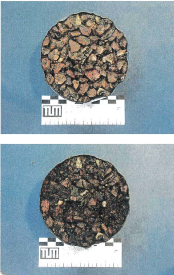
Bild 3: Probekörper des offenporigen Asphalts mit Gesteinskörnung GK 7 vor (oben) und nach (unten) den 28 Frost-Tau-Wechseln im CDF-Versuch
