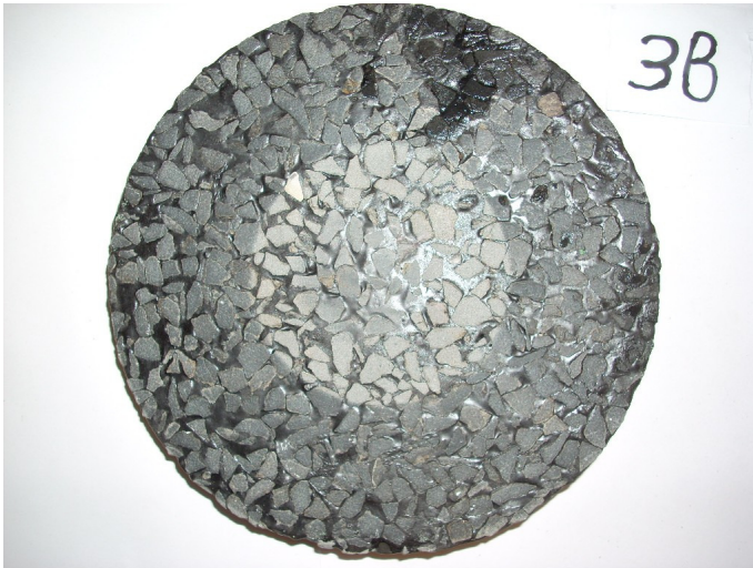
Bild 7: Basalt-Probekörper – Mastix-Einbettverfahren, Foto: Labor 9
