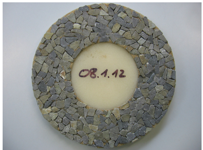
Bild 6: Kalkstein-Probekörper – Mosaik-Auslegeverfahren, Foto: Labor 8
