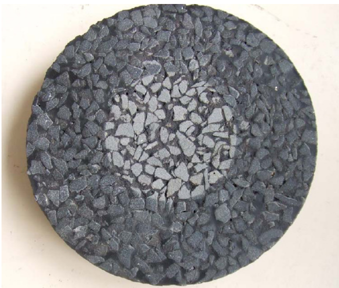
Bild 9: Basalt-Probekörper – Mastix-Einbettverfahren, Foto: Labor 7
