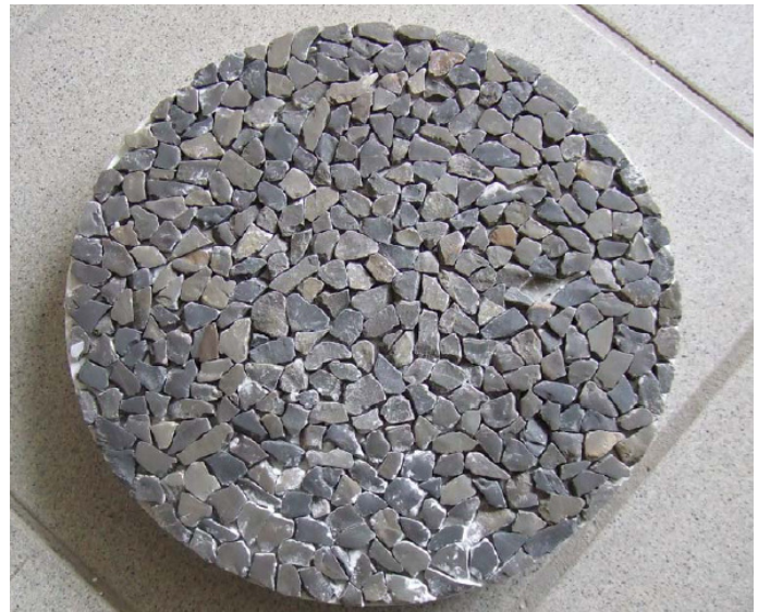
Bild 5: Kalkstein-Probekörper – Mosaik-Auslegeverfahren, Foto: Labor 7
