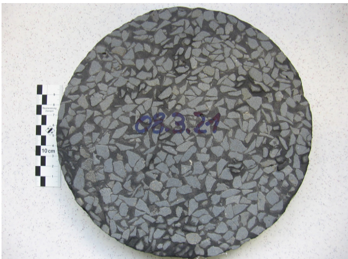
Bild 8: Basalt-Probekörper – Mastix-Einbettverfahren, Foto: Labor 8
