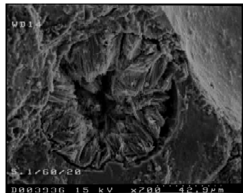
Bild 1: Straßenbeton 1: Ende 3. Belastungsstufe Pore fast mit kompakten Ettringitformationen gefüllt
