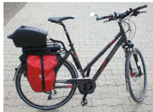
Bild 2: Elektrofahrzeug mit fest installiertem Messequipment
