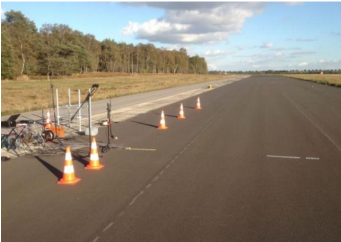
Bild 5: Messanordnung zur Bestimmung der ortsabhängigen Schwingschnelle sowie der Luftschallemission der Fahrbahnoberflächen bei mechanischer Anregung der Fahrbahnoberflächen durch kontrollierte Vorbeifahrt eines Pkw
