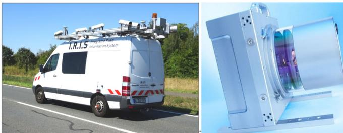
**Bild 1:** Bild links: Mobile Mapping Fahrzeug IRIS12 - Bild rechts: Clearance Profile Scanner CPS zur Aufnahme der Testdaten
