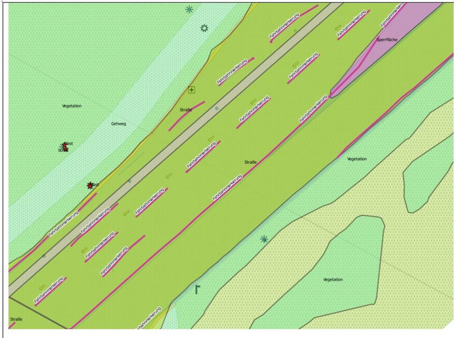
**Bild 6:** Überlagerte Darstellung von Referenzdigitalisierung und automatisch extrahierten Punkt-, Linien- und Flächenobjekten (alle automatisch gefundenen Objekte sind beschriftet)
