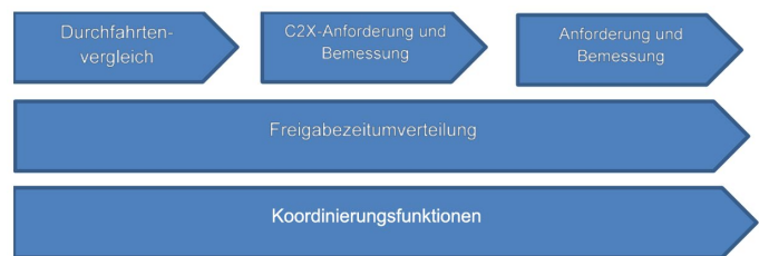
Bild 1: Sequenzielle und parallele Abarbeitung der Steuerungslogik
