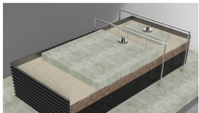
Bild 8: Großmaßstäbliche PK im Versuchsstand (schematische Darstellung)
