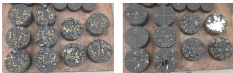
Bild 2: Oberseiten (links) und Unterseiten (rechts) einer Auswahl der hergestellten MPK (je Bild links AC 45 B/T S, rechts AC 45 T S, WB1 weist Rückstände von weißem Filterpapier an der Unterseite auf)
