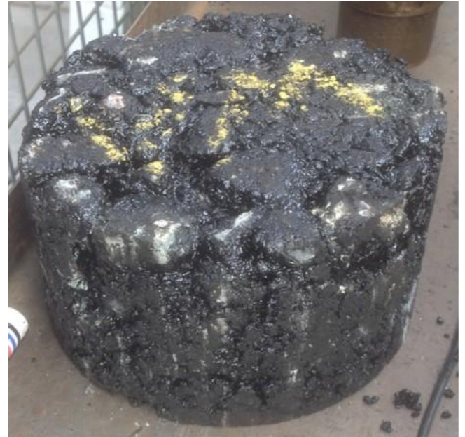
Bild 5: Beispiel für Kornzertrümmerung und ungefüllte Hohlräume an MPK WA1 (AC 45 T S)
