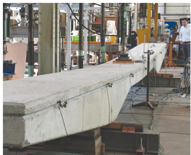
Bild 2: Verformungszustand Last in Feldmitte
