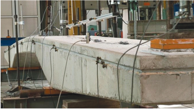
Bild 3: Verformungszustand, Last auf Kragarm
