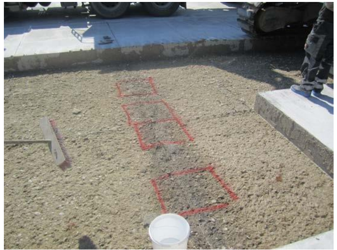
Bild 4: Oberfläche der modifizierten Kiestragschicht KTSuB im Fugenbereich, die Entnahmestellen sind rot markiert
