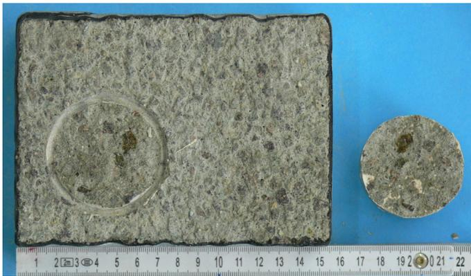
**Bild 7: Kohäsionsbruch in der oberflächennahen Schicht der CEM II/A-S-Probe WaBe A8-18 (20 °C / 65 % rel. F.; 26 N/mm²) im Betonalter von 9 d mit Oberflächenzugfestigkeiten von 2,6 N/mm²**
