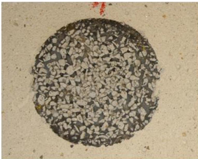
Bild 14: Bohrkern aus der Einbaustrecke nach 300 Minuten Polierdauer
