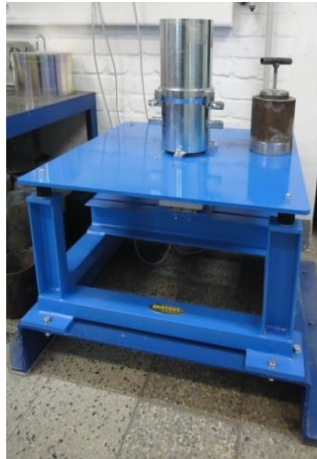
Bild 4: Vibrationstisch nach DIN EN 13286-5
