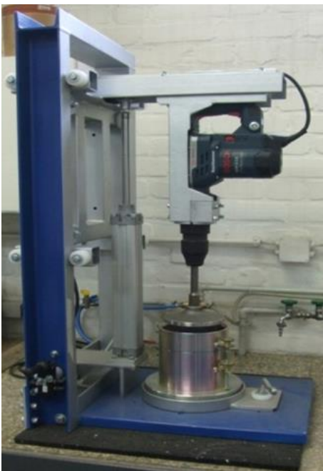
Bild 3: Vibrationshammer nach DIN EN 13286-4
