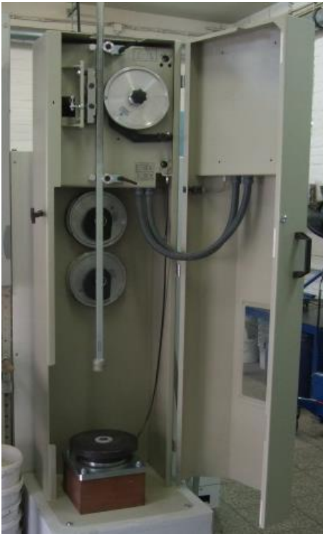
Bild 2: Proctorverdichter nach DIN EN 13286-2
