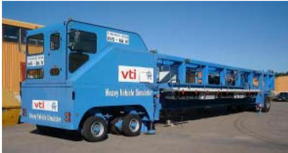
**Bild 3: HVS (Heavy Vehicle Simulator) des VTI in Schweden [WIE 08]**
