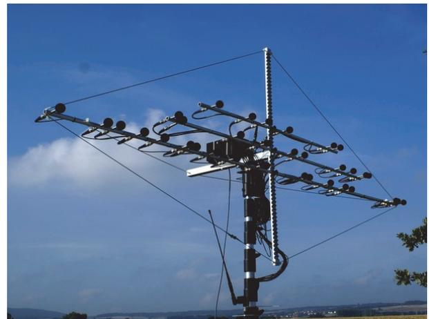
**Bild 1:** Die drei linearen Arrays auf einem gemeinsamen Träger zusammen mit der Elektronik zur Datenerfassung.
