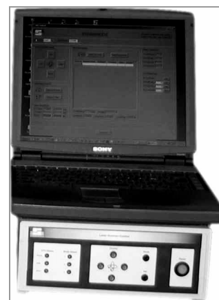
Bild 1: Prototyp des Gruben-Volumen-Scanners mit Steuereinheit und Laptop
