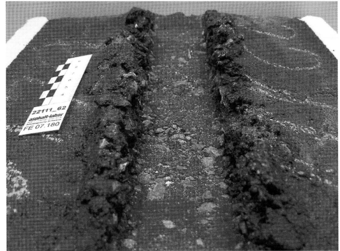
2: Spurrinnenfläche bei Asphaltbeton 0/11S (6,2 M.-% Bindemittel) unter der Prüfbedingung „Wasser, 50 °C, Stahlrad eben“
