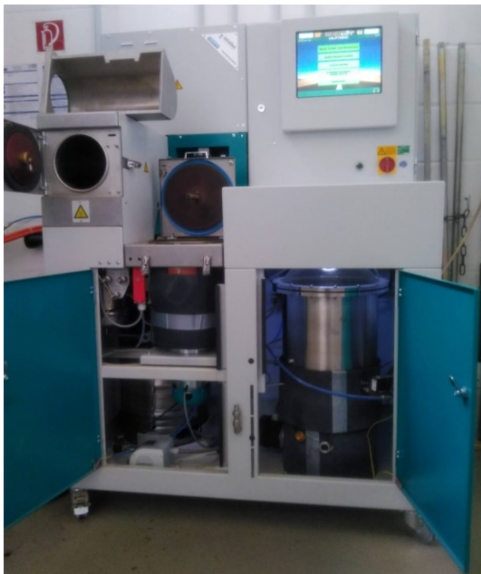
Bild 2: Vollautomatische Extraktionsanlage mit OME als Lösemittel am ISBS, oben mit geschlossenen und unten mit geöffneten Türen
