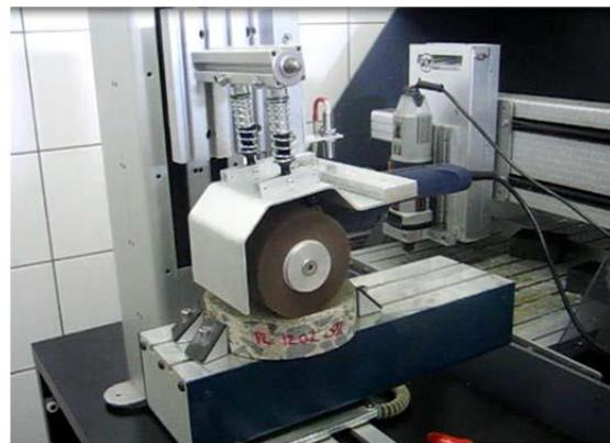
**Bild 4:** Poliervorrichtung (Prototyp)
