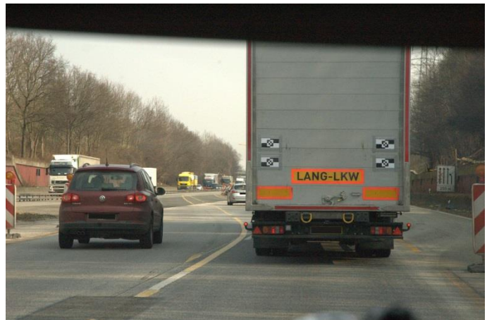
Bild 2: Fahrt eines Lang-Lkw durch eine Überleitung
